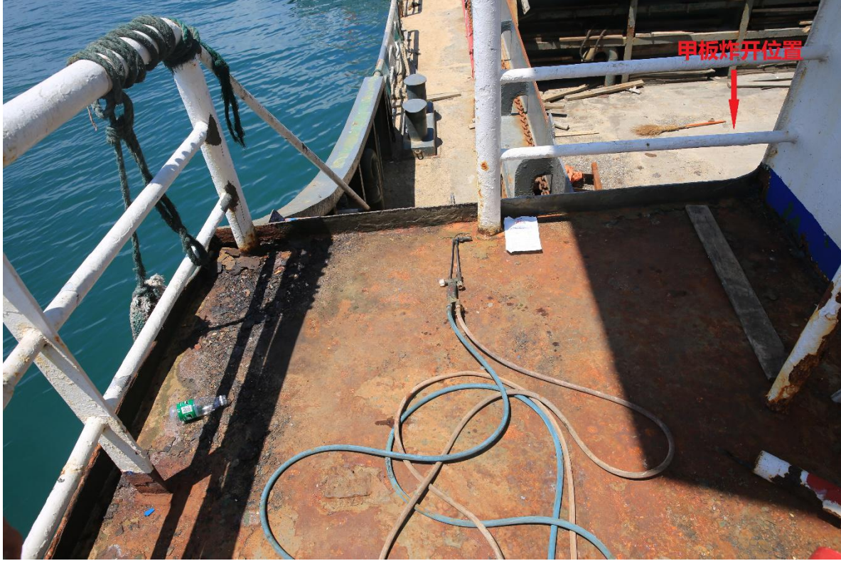
图 5: 二层甲板上的气割设备
